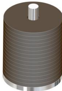
Embase mécanosoudée avec pieu central, sans coffrage, avec lests incorporés à quai ou en mer
